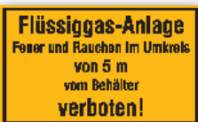
Flüssiggas-Anlage Feuer und Rauchen im Umkreis von 5m vom Behälter verboten!
